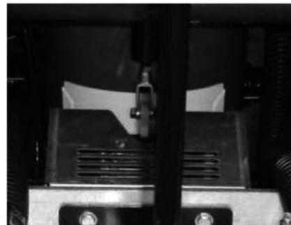
**3) Des protecteurs ( fixes, interverrouillés, etc.)doivent être installés sur les courroies et chaines d'entraînement (zone 6).**
